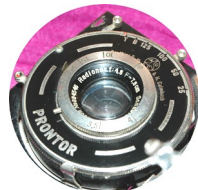
KorelleにはPRONTORシャッターのRadionar 7.5cm F4.5レンズが装着されていた。
